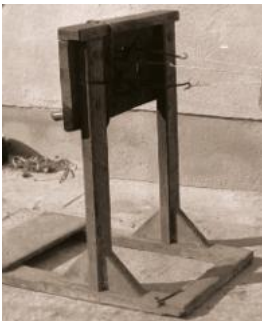
Rys. 19 – Maszyna powroźnicza Daniela Krna używana później przez Jozefa Sokola
